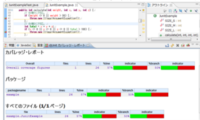
図 djUnit によるカバレッジ計測結果:カバレッジの値と未実行の行が分かる
