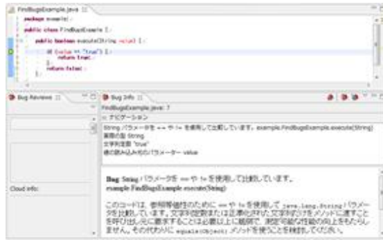
図 Eclipse 上での FindBugs の実行結果：チェックされた箇所と違反内容が分かる
