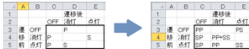
図 状態遷移表(左)から1スイッチの状態遷移パスを自動生成(右)
