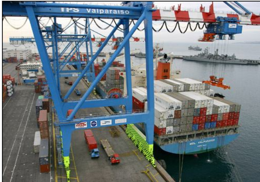
Figura 8-B. Grúas Gantry marca ZPMC para naves Post-Panamax
