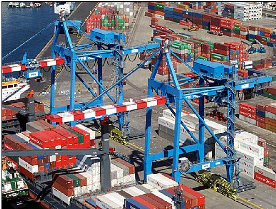
Figura 8-A. Grúas Gantry marca Kocks Krane para naves Panamax.
