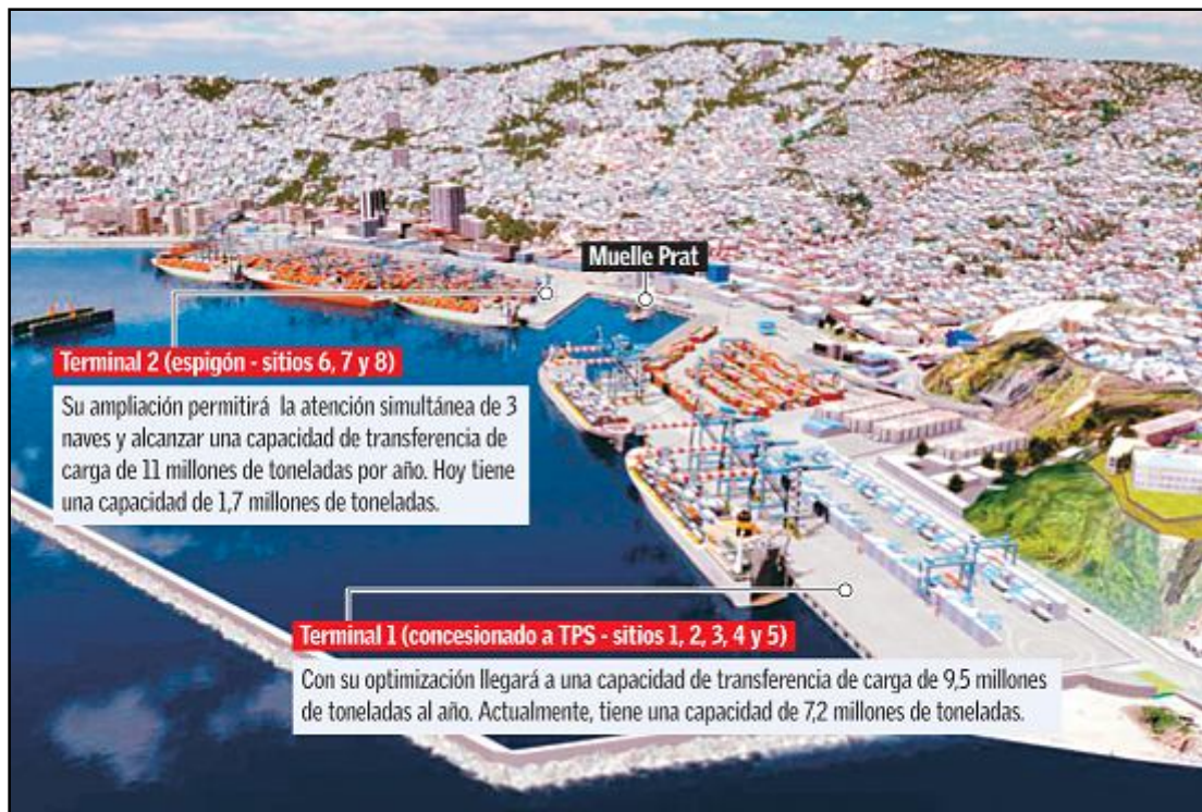
Figura 21-A. Proyecto de Ampliación del Muelle.
