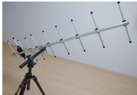
3. スマホには、方位(水平)角・仰角を簡単に示すアプリがたくさん存在する。便利な世の中になったものだ。Windows10\_PC で事前に あるいはリアルタイムで衛星の方向がわかるので(後述)、衛星にアクセスのしやすい最大仰角時(TCA)の方向にアンテナを向けておくか、または、時々刻々とアンテナ方向を手動で微調整すればよい。スマホ・アプリを起動して、指向性アンテナのブーム方向にスマホを添えるだけで数値が示される。
