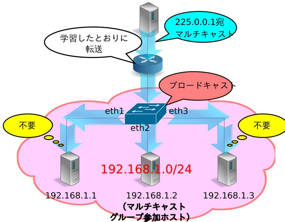
IGMP スヌーピングは、マルチキャストグループ参加ホストからマルチキャストルータに送信される IGMP Report Message を L2 スイッチが覗き見る (snoop) ことでマルチキャストパケットの転送先ポートを学習する、という手法です。この手法により、サブネット内においてもマルチキャストグループ参加ホストが存在しないポートに対してマルチキャストパケットが送信されることはなくなり、不要なトラフィックを削減することができます。
