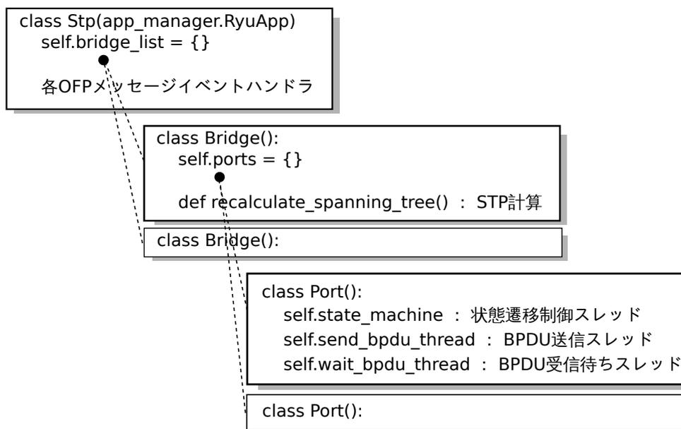
STP ライブラリ (Stp クラスインスタンス) が OpenFlow スイッチのコントローラへの接続を検出すると、Bridge クラスインスタンス・Port クラスインスタンスが生成されます。各クラスインスタンスが生成・起動された後は、
