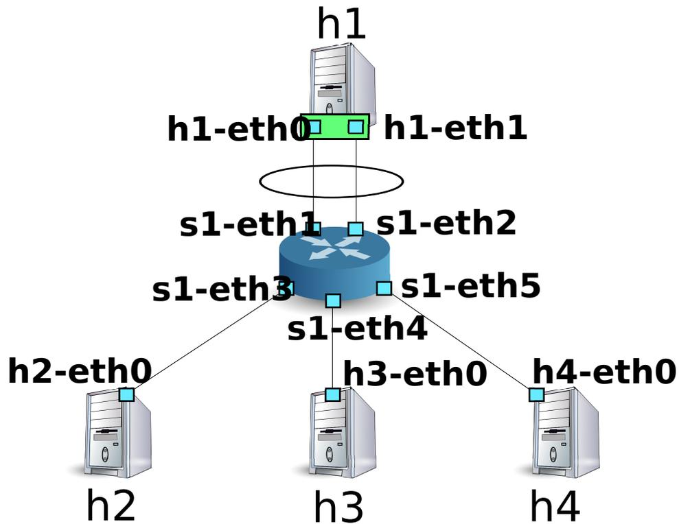
Mininet の API を呼び出すスクリプトを作成し、必要なトポロジを構築します。
