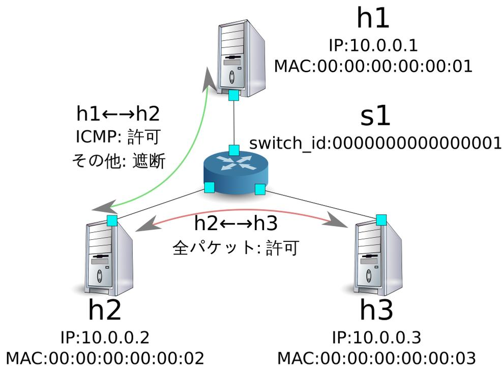
実際に確認します。h2 と h3 の間の ping(ICMP) を遮断するルールが削除されたため、ping が疎通できるようになったことがわかります。
