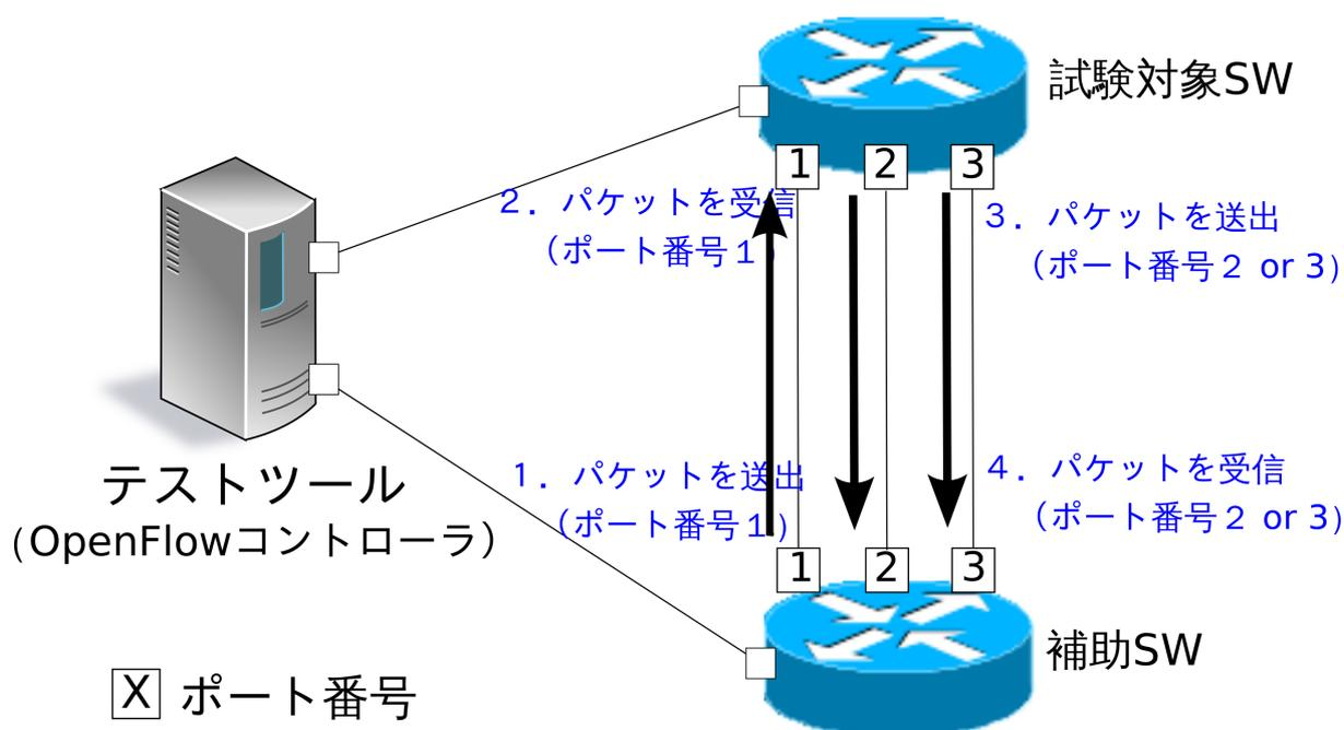
図の通り、Group\_mod メッセージのテストを実施するケースのみ、試験対象 SW のパケット送信用ポート 2 及び補助 SW のパケット受信用ポート 2 を利用する場合があります。
