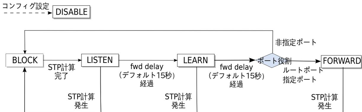
これらの処理が各ブリッジで実行されることにより、フレーム転送を行うポートとフレーム転送を抑制するポートが決定され、ネットワーク内のループが解消されます。
