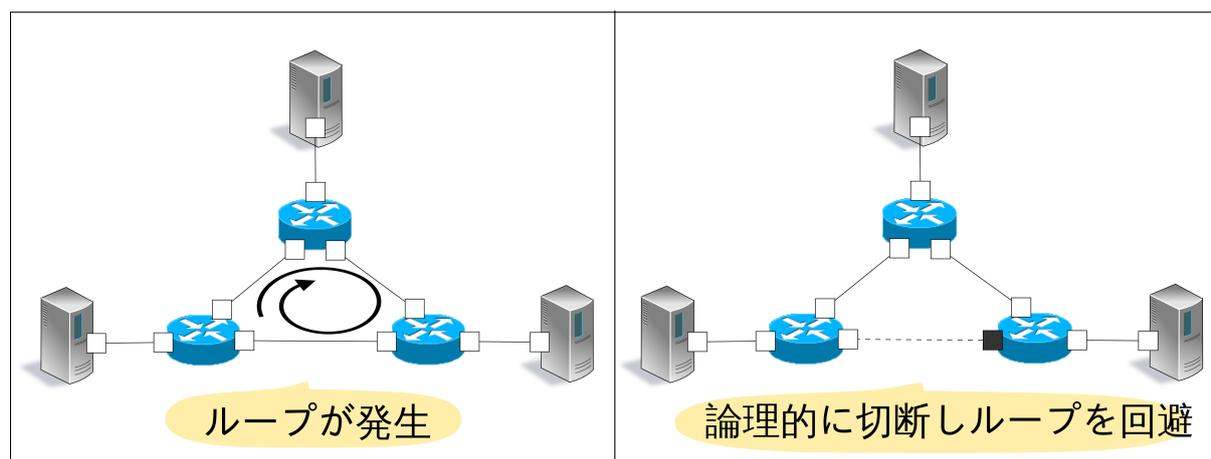
STP ではブリッジ間で BPDU(Bridge Protocol Data Unit) パケットを相互に交換し、ブリッジやポートの情報を比較しあうことで、各ポートのフレーム転送可否を決定します。
