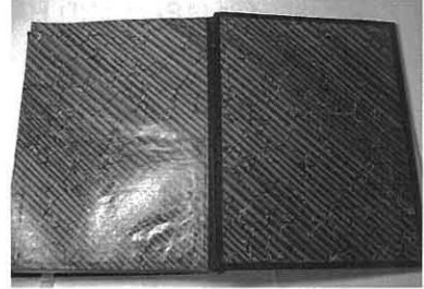
写真2.5.4 ノドのクロスの切れ目
