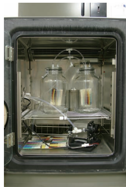
写真5. 恒温恒湿装置内部、放射状に設置した試験片
