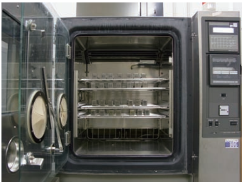
写真3. 恒温恒湿装置内部
