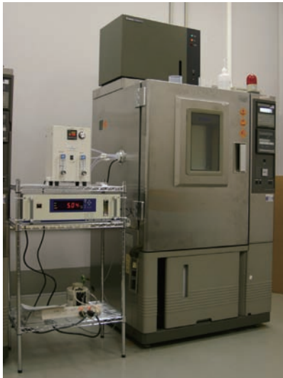
写真4. オゾン曝露試験装置 [エコデザイン (株) ED-OX-16]、恒温恒湿装置 [スガ試験機 (株) PR-1SP]
