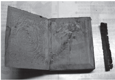
写真3.5 糊が劣化していたため、表の紙が簡単に剥がれた
