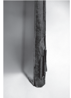
写真13.4 側面のテープの破損
