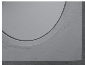
写真2.2.2, 3 窓マット破損部分
