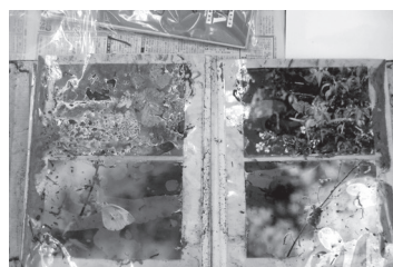
図23 カバーと吸着して剥離不可能となったプリント
