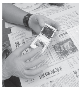
図24 水分がマウント内部にまで侵入したリバーサルフィルム
