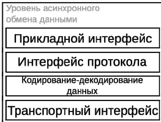
Рис. 5. Структура модуля асинхронного обмена данными
