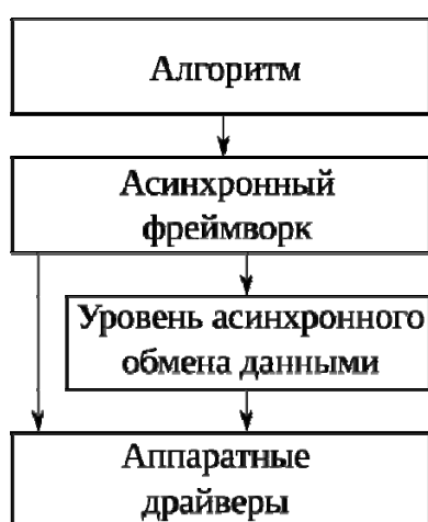
Рис. 4. Архитектура программного обеспечения робота
