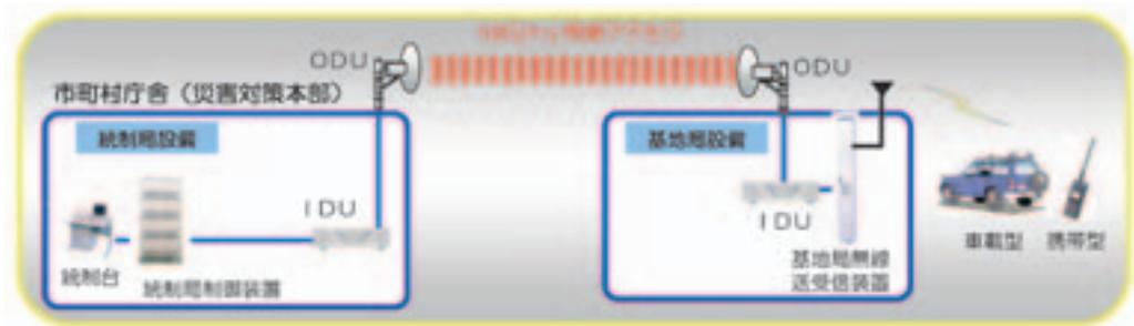
図3-1-10 無線アクセスの適用事例（固定局回線としての利用）
