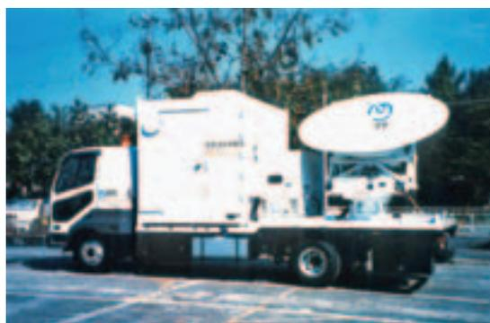
写真 デジタル衛星車載車
