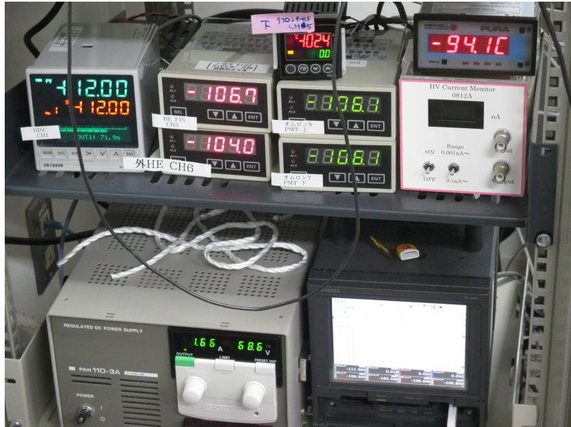
図 3.22: 温度コントローラーおよび、各温度計表示、キセノンラインに設置した露点計の表示装置、データロガーの写真。左上がPID制御を行う温度コントローラー、左下はヒーター電源で、右下がデータロガー、右上にキセノンラインに接続した露点計の表示がある。その他温度計の表示もまとめてこの棚に置いてある。
