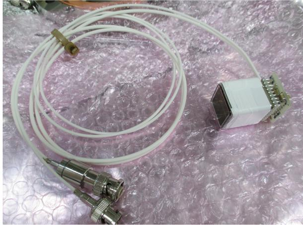
図 3.3: 浜松ホトニクス製の PMT R8520-406 と + HV のプリーダ回路基板。
