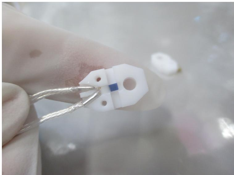
図 3.21: 白金温度計。中央の青い部分。写真は装置に固定するためのテフロン製温度計ホルダーにはめ込んだ様子。熱交換ボックス内部の fin と、IVC 内部の PMT 付近にはこのホルダーごとねじ止めして温度計の固定を行っている。
