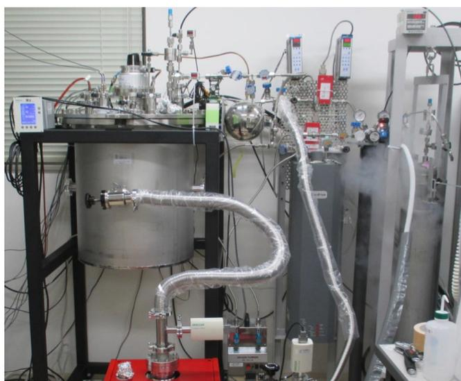
図 3.1 テストベンチ全体。左側の円筒形の容器が検出器の入った外真空容器で、右端が Xe ボトルである。
