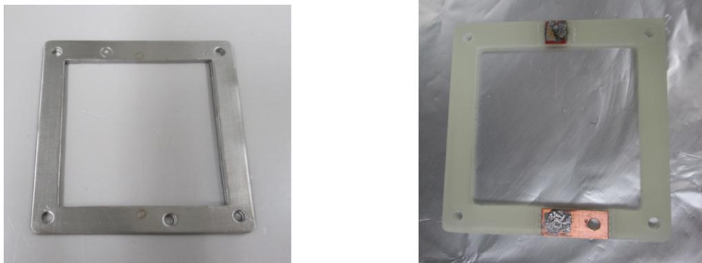
図 3.11 作製したワイヤー電極。左が SUS を、右がガラスエポキシをフレームに使用した電極である。両方とも中心に 1 本の金メッキタングステン線が張られている。
