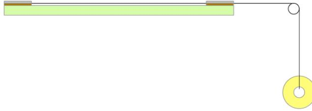
図 3.12 ガラスエポキシフレームへのワイヤーのはんだ付け方法の模式図。まず左側をはんだ付けし、5円玉をくくりつけたワイヤーを垂らして張力をかけた状態で右側をはんだ付けする。
