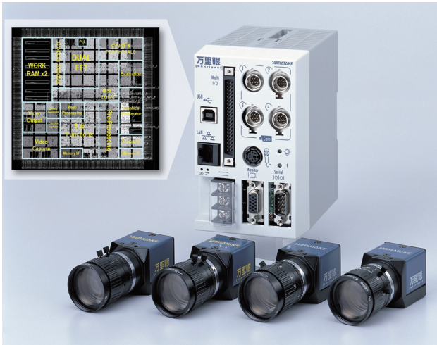
図5 超高速画像認識システムと専用LSI
