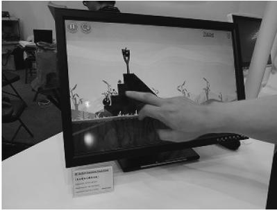
写真1 Abon製表面型静電容量方式タッチパネル
