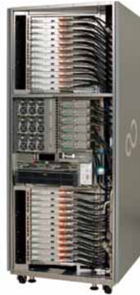
図13 CPユニットを実装したスパコンラック Fig. 13. Rack of super computer equipped cold plate units.
