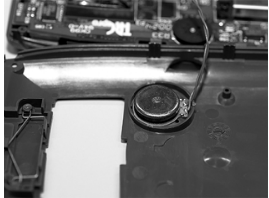
図 1: アクチュエータの設置状況 PDA の筐体に貼り付けている。
