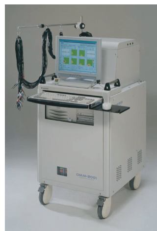
図 3 fNIRS 計測システム (OMM-2001, 島津製作所製)
