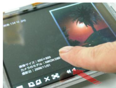
図 5 近接ジェスチャによる操作パレットの引き出し
