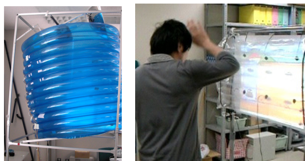
図1 上肢運動をサポートするディスプレイ (左：包囲型、右：対面型)
