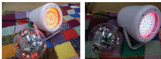
図4 LED 照明を制御する応用例。カメレオンボールに同調して照明の色や明るさが変化する。
