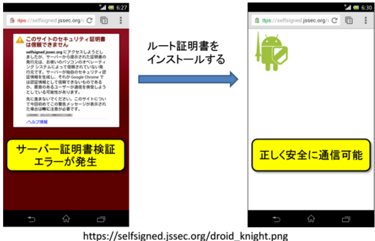
図 5.4.4 ルート証明書のインストール後はプライベート証明書を正しく検証できるようになる
