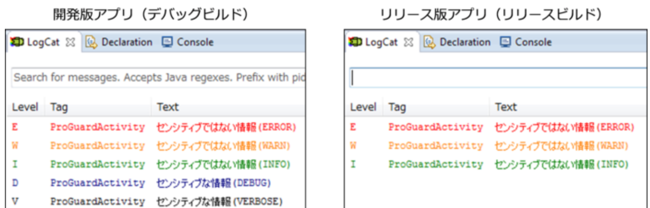
図 4.8.2 Log メソッドの開発版アプリとリリース版アプリの LogCat 出力の違い
