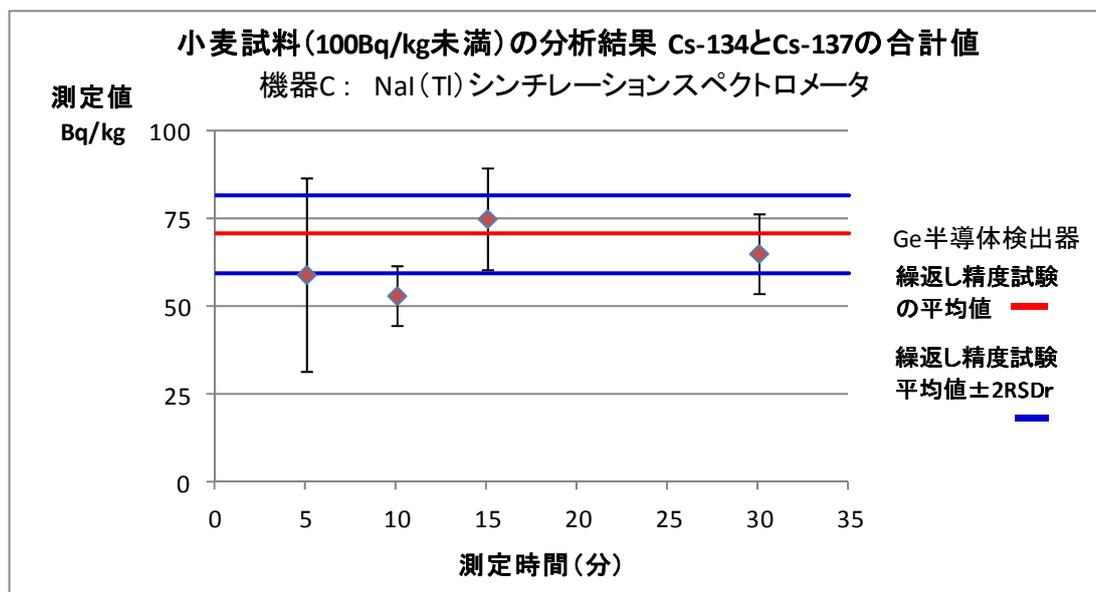
これらの結果からは、小麦試料の測定について、ゲルマニウム半導体検出器での測定結果とNaI (Tl) シンチレーションスペクトロメータの測定結果は近い値が得られることがわかりますが、測定時間は最低でも10分間程度、機器によっては20分間程度の測定時間が必要であることがわかります。
