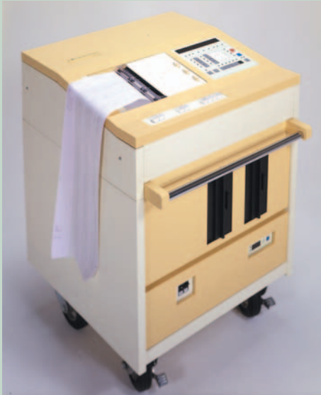
FCP-300 マイクロコンピュータを内蔵した世界初のマイ コン心電計(1979年)
