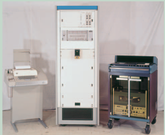
ECP-100 コンピュータ本体（中央）、心電図端末装置（右）、テレタイプ（左）
