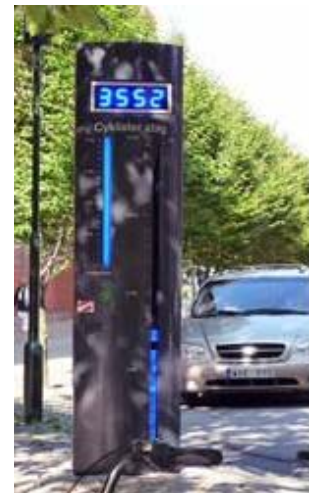
自転車の交通量を測定するカウンタ
