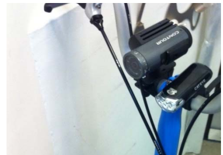
自転車へのビデオカメラ取付け例
