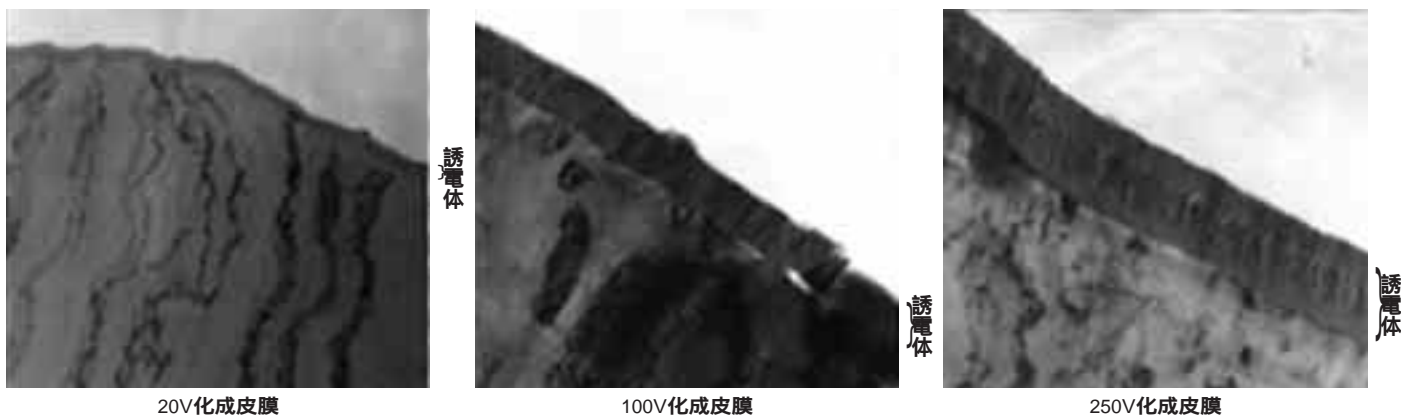
写真 1-3 誘電体(アルミニウム酸化皮膜)断面写真(プレーン箔表面に誘電体を生成したもの)
