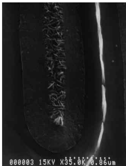
写真 1-4 中高压化成箔の断面写真 (ピットに生成された酸化皮膜の状態)
