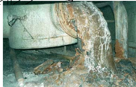
図13. 空っぽだった炉心(上)と溶岩状になって流れ落ちた核燃料(下)。
