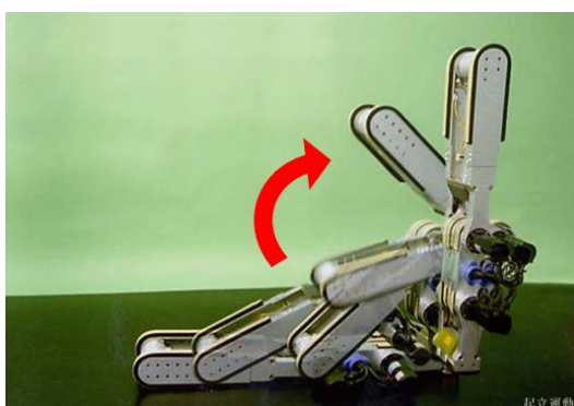
図 IV-6 ロボットの起き上がり実証実験の様相 (ATR 森本淳氏、銅谷賢治氏の研究成果)
