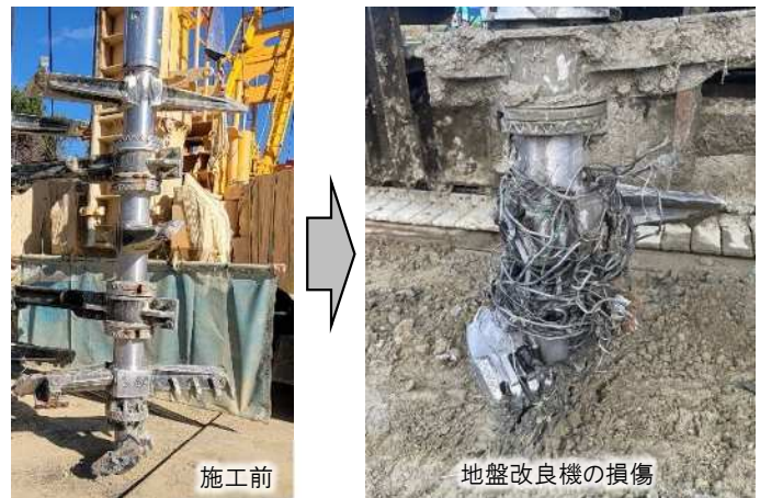
<地中の混入物による地盤改良機の損傷>
