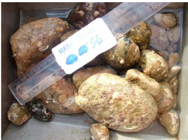
Photographie d'un échantillon prélevé à la benne d'un substrat de cailloutis (noter la règle qui donne une indication de l'échelle)
