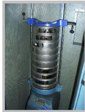
Détermination de la répartition de la taille des grains d'un échantillon de sédiment (à gauche) par des techniques de tamisage à sec (au centre) et humide (à droite) (photos gracieuseté du Cefas)
