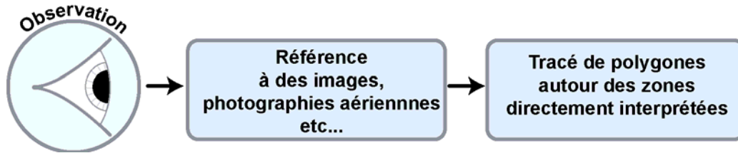
Schéma d'une approche de cartographie directe
