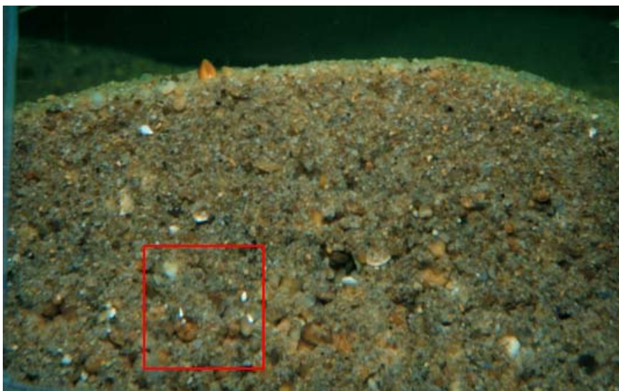
Image d'IPS agrandie d'un sédiment grossier, dont on a choisi une partie représentative (rectangle rouge) où l'on mesurera la taille de chaque grain afin de déterminer la répartition de la taille des grains (photo by R. Diaz).
