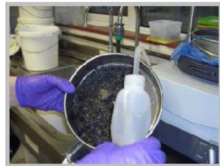
Détermination de la répartition de la taille des grains d'un échantillon de sédiment (à gauche) par des techniques de tamisage à sec (au centre) et humide (à droite) (photos gracieuseté du Cefas)
