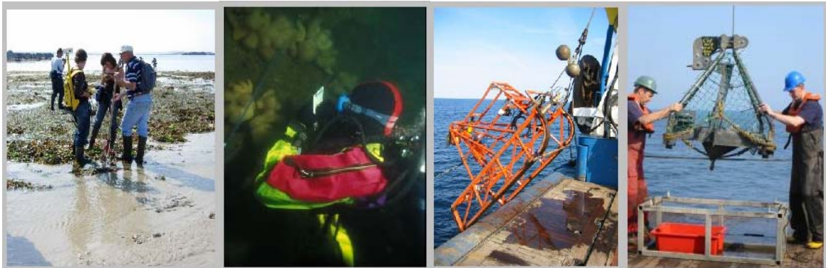
Exemples de diverses techniques de campagne de terrain. De gauche à droite : levé à pied, plongée en eau peu profonde, levé vidéo, prélèvement à la benne. (Crédits photo : 1 et 2 – JNCC, 3 et 4 – Cefas)
