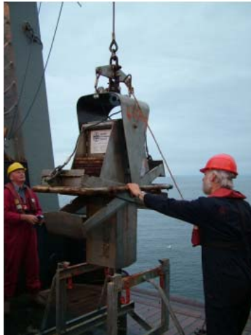
Opérations sur le pont – Utilisation d'un carottier-boîte
