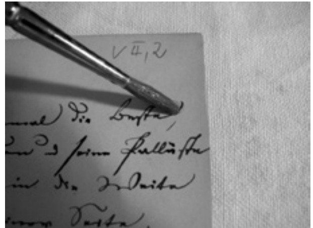
Behandlung der aggressiven Eisengallustinten mit eisenionbindendem Phytat.
