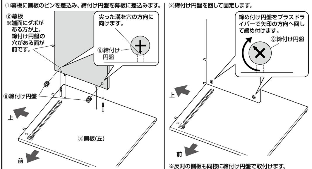
※反対の側板も同様に締め付け円盤で取付けます。
