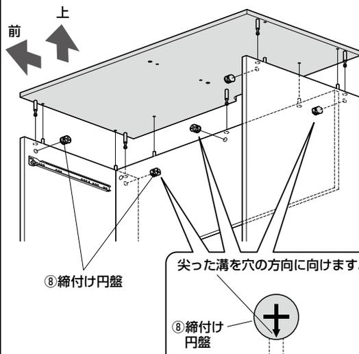
(2) 締め付け円盤を回して固定します。(5ヶ所)
