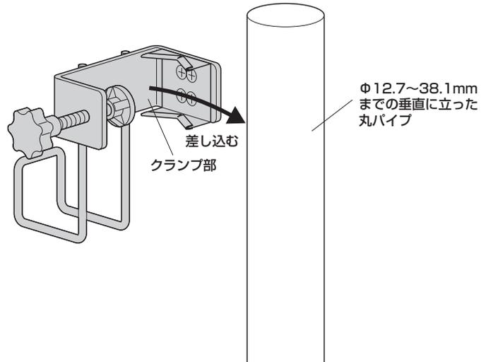
②ノブボルトを締め付けて固定します。
