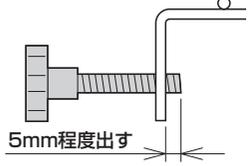
**4** ノブボルトの先端にクランプパッドを取付けます。
