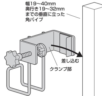
②ノブボルトを締め付けて固定します。
