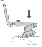
5.吸盤ロックレバーを下ろします。 ※しっかりと固定されていることを確認します。
