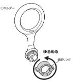
2.吸盤マウントに調節リング、ホルダーの順に涌し(A)、調節リングを回して固定します。(B)
