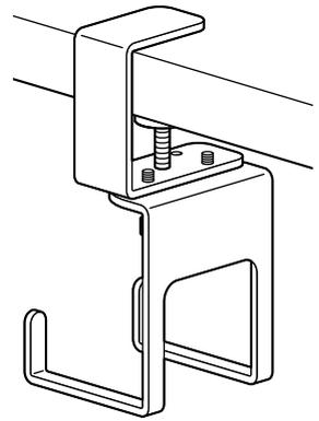
**1** クランプから付属のボルトを取外します。
