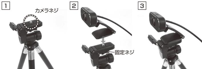
スタンド裏面の三脚穴に、三脚のカメラネジを取付け、固定ネジをまわして固定します。
