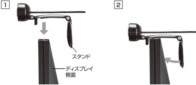
本製品を液晶ディスプレイにのせます。ディスプレイの厚みに合わせて、スタンドを動かしてディスプレイを挟み込み、設置します。
