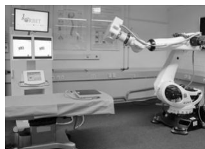
Roboterarm mit Röntgenquelle Zielgebiet der Röntgenaufnahme Roboterarm mit Röntgen-Flachbilddetektor
