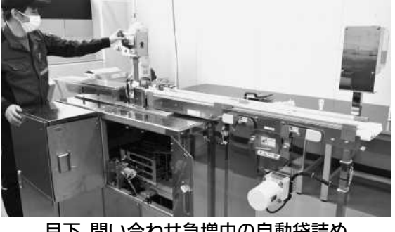
目下、問い合わせ急増中の自動袋詰め包装機「パケッチPro」
