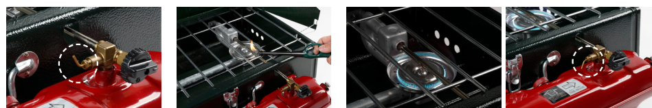
1. 点火レバーを上向きにセットする。 2. 柄の長いライターなどの火種を先にメインバーナーに近づけてから、燃料バルブを開ける。左に1～2回転させると点火する。点火直後、すぐにノブが固くなるまで、十分にポンピングを行う。 3. 点火直後の赤い炎から正常な青白い炎に安定したら、点火レバーを下向きにする。火力の調節は燃料バルブで行う。
