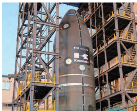
試験の様子。巨大なフェアリングがロケットからの分離信号を受けて左右に分離し、貝が開くように機体から離脱する仕組み。
