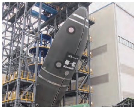
試験の様子。巨大なフェアリングがロケットからの分離信号を受けて左右に分離し、貝が開くように機体から離脱する仕組み。
