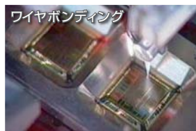
ワイヤボンディング つくりこみと同時に 出来映えをチェック
