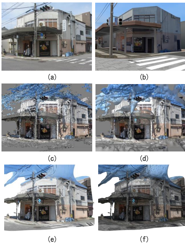
図4. 水木しげるロード周辺建物3次元モデル: (a) 現況写真, (b) 従来手法で作成, (c) SfMソフト(PhotoScan)で作成した点群, (d) 同 ポリゴン, (e) SfMソフト(Remake)で作成したポリゴン, (f) 同メッシュ表現
