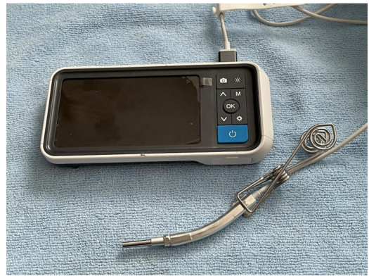
図 6 厚みのあるブレードにも対応できる汎用クリップ型と 4.5 インチモニターの録画器本体
