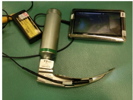
図 1 これまで使用してきた喉頭鏡ブレードに装着するビデオカメラシステム 1)
