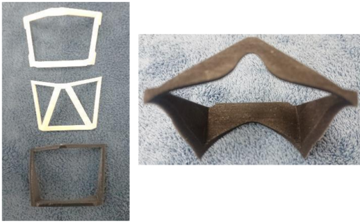
図 7 本案マスクのフレーム (ナイロンで 3 D プリント) と連結部材 (Agilus ゴムで 3 D プリント) の試作
