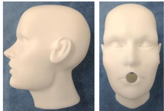
図 6 装着対象として作成したダミーヘッド（1/2縮尺） マスク試作時のリークをテストする目的で10mmの孔を設けている
