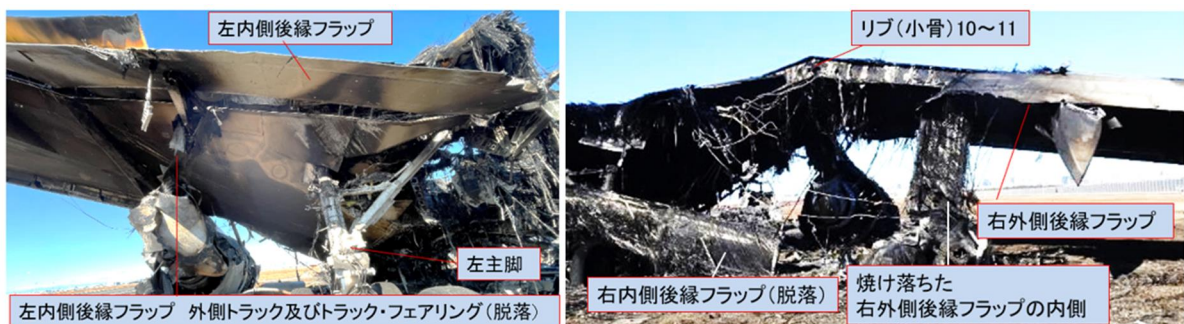
図35 主翼の状況（後方より）左写真：左主翼 右写真：右主翼
