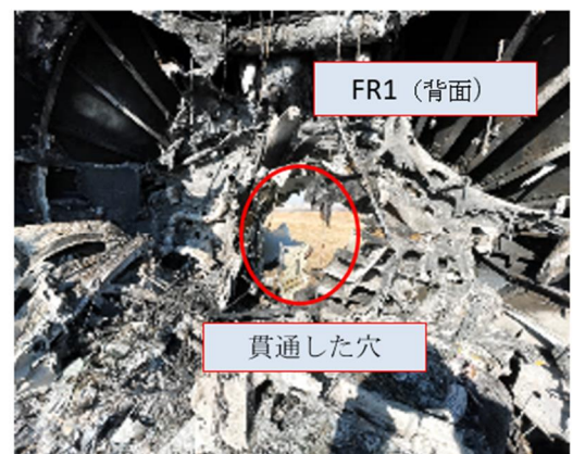
図 3 4 - 6 B機の機首部分（内部）
