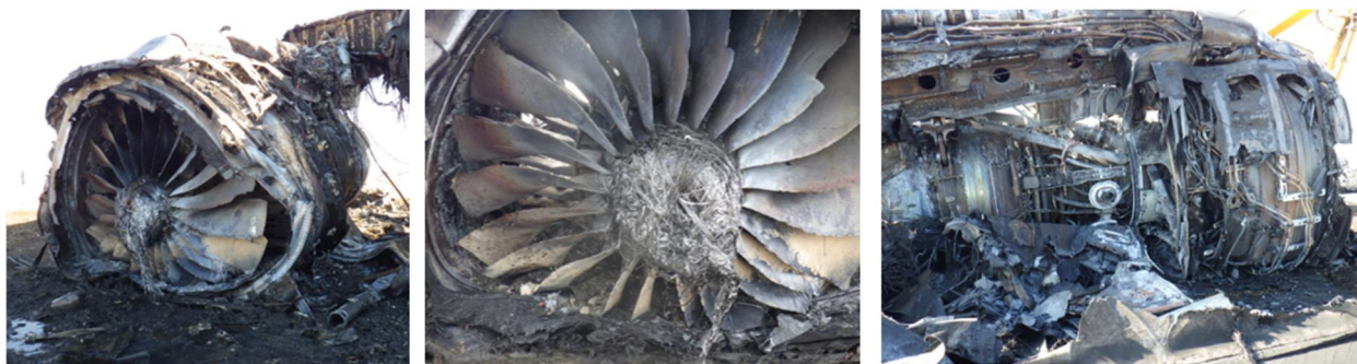
図3 7 右エンジンの損傷の状況
