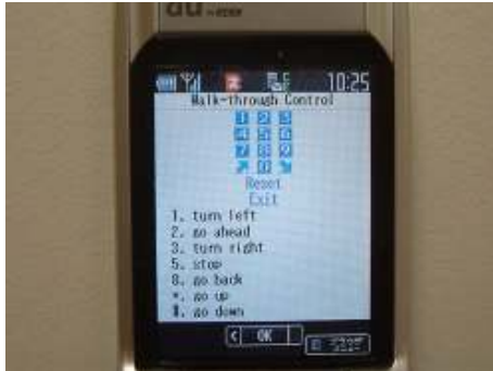
図 4-2-3 携帯電話によるウォークスルー機能のインターフェイス画面
