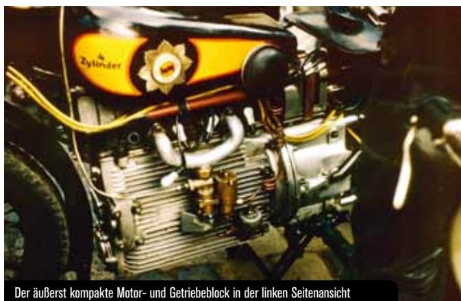
Der einzelne Vergaser am stark gerippten Motorblock ist gut zu erkennen
