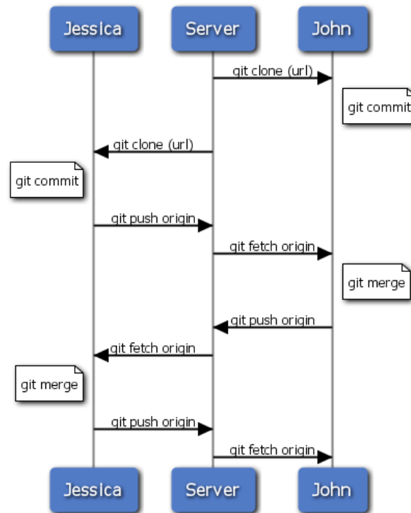
図 5.11: 複数開発者での Git を使ったシンプルな開発作業のイベントシーケンス
