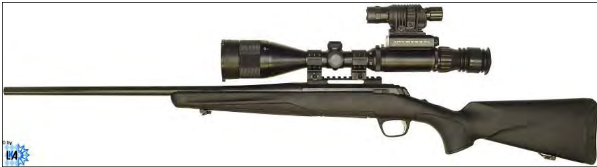
Abb. 76: Im Praktikabilitätstest eingesetzte Repetierbüchse „Browning X Bolt Composite Stalker“ mit Hakko-Zielfernrohr und Restlichtaufsatz
